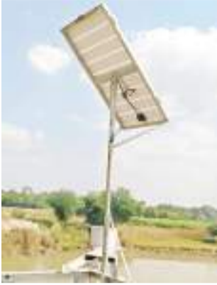
रोड-चोपन के मध्य कोयल नदी पर पुल संख्या 2 पर वाटर लेवल मॉनिटरिंग सिस्टम लगाया गया है...
